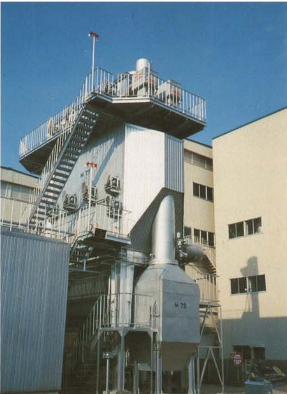
形式/4HD-18 用途/産業廃棄物焼却炉 ガス量/20,000Nm 3 /Hr ガス温度/300℃
