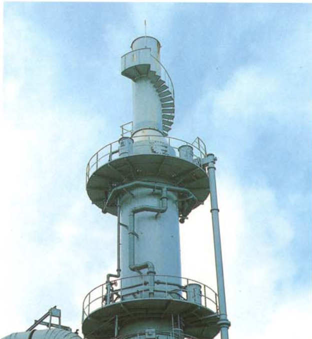
形 式：WCV 用 途：ガラス溶解炉 ガス量：50,000Nm 3 /H ガス温度：60℃
